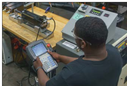
最终系统测试确保反馈设备与 ServoWeld 电机的各极对准。
